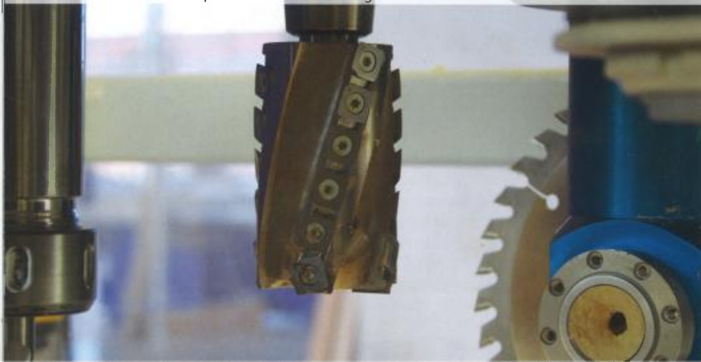
2: Beim Bohrfräser Castor Sprint lassen sich alle Schneiden einzeln tauschen – und spart damit die Zeit für einen Komplettwechsel des Werkzeugs
