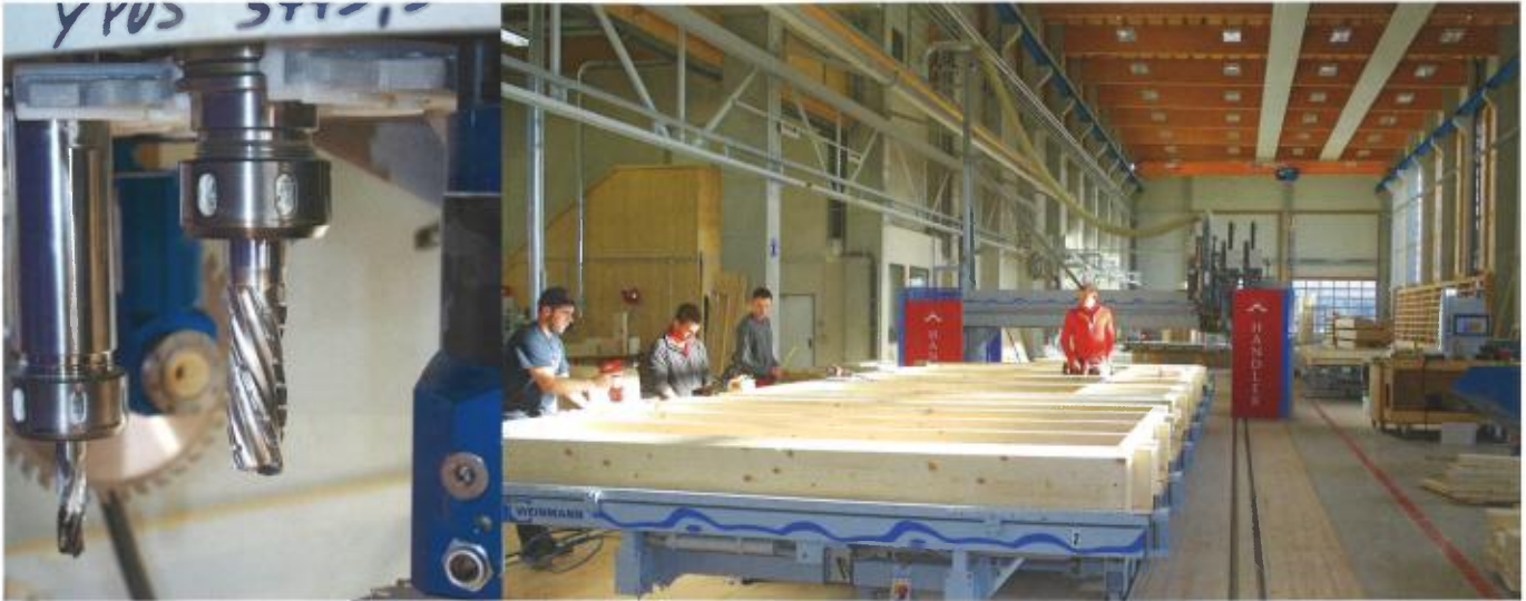
3: Schaftfräser mit langen Standzeiten: Seit der Fräser mit Diamantschneiden bestückt wurde, hat sich der Verschleiss bei der Bearbeitung von Putzträgerplatten deutlich reduziert.
